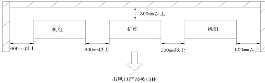
侧吹型安装示意简图
