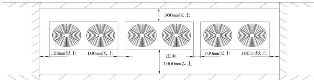
顶吹型安装示意简图
